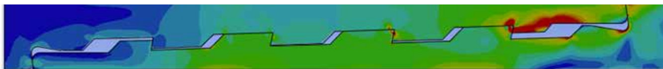
Figura 2 - Representación típica de cómo se asientan las tensiones de precarga en una rosca de inicio único utilizando el mapeo térmico. Las tensiones dentro de la conexión suelen concentrarse cerca de la envoltura completa final de la rosca del perno. (mostrada en el lado derecho del modelo).
