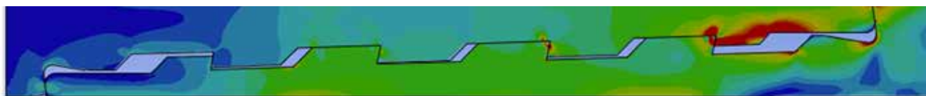
Figure 2 - Représentation typique de la façon dont la contrainte de précharge s'installe dans un filetage à départ unique à l'aide de la cartographie thermique. Les contraintes à l'intérieur de l'assemblage se concentrent généralement près du dernier enroulement complet du filet de la broche (illustré sur le côté droit du modèle).
